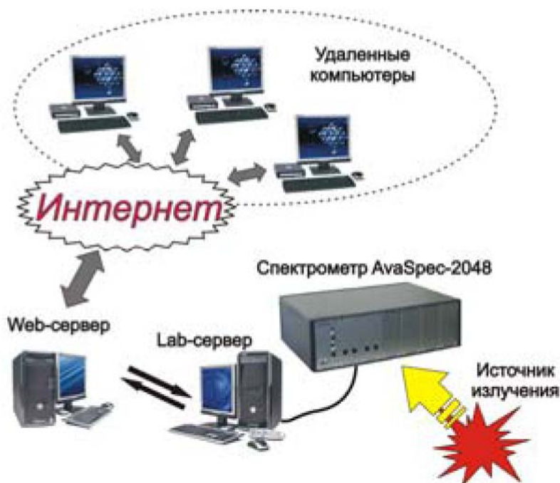
Рисунок 1. Схема проведения спектральной диагностики через глобальную сеть.
