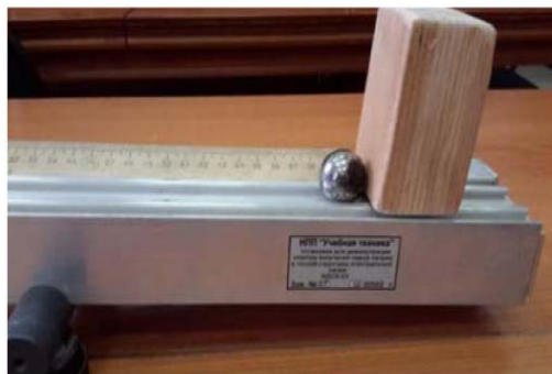
Рисунок 1. Внешний вид установки для изучения упругих свойств древесины (слева), зависимость величины отскока шара от угла поворота бруска (справа).
